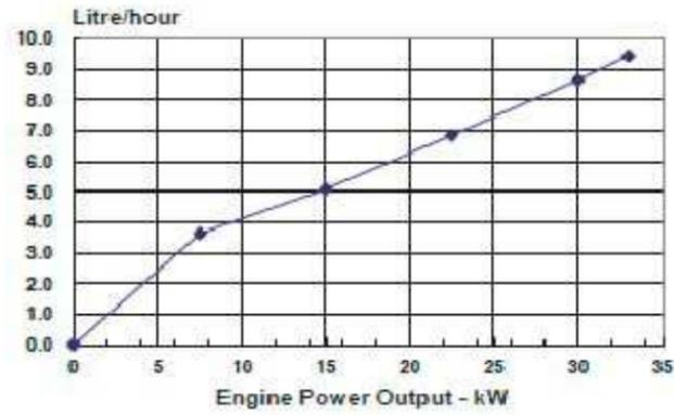
Las curvas mostradas anteriormente representan las capacidades de rendimiento de los motores en bruto, obtenidos y corregidos en acuerdo con GB/T18297 en condiciones de 100 kPa (29,61 in. Hg), presión barométrica [80 m (263 ft.) altitud], 25 °C (77 °F) entrada de la temperatura del aire y 1 kPa (0,30 in. Hg) presión de vapor de agua con No. 0 combustible diesel.
